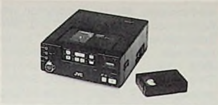
Bild 11: Videorecorder mit VHS-Minicasette (JVC-Pressbild)
